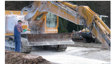
Vorgängige Desinfektion von Baumaschinen, welche in Gewässern mit heimischen Flusskrebsen zum Einsatz kommen. Foto: R. Hennings
